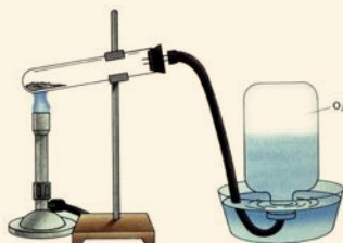
شکل (6-7) استحصال اکسیجن از پتاشیم کلوریت
