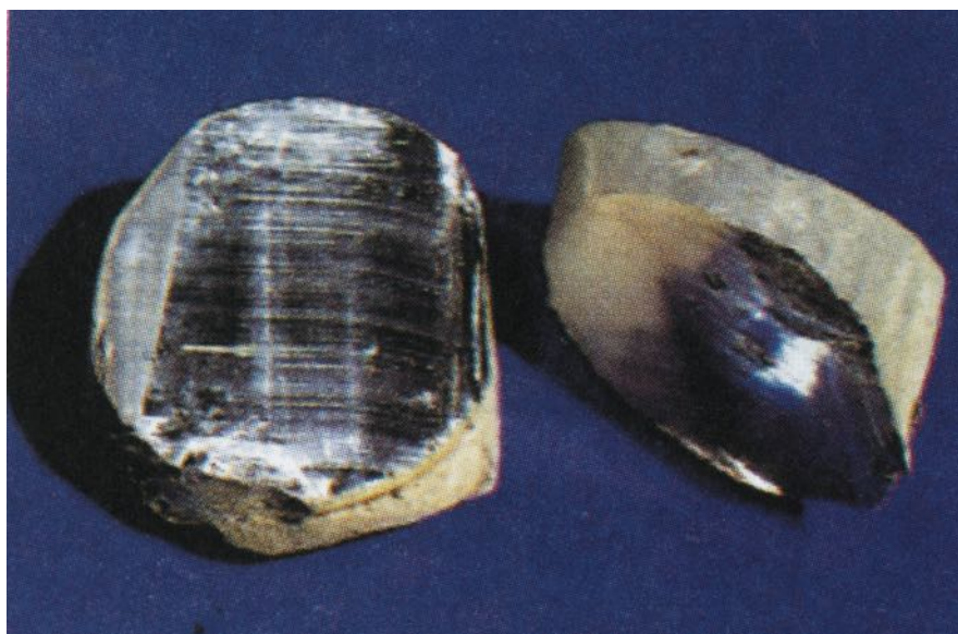
شکل (5-6) زنگ زدن سودیم در موجودیت هوا
