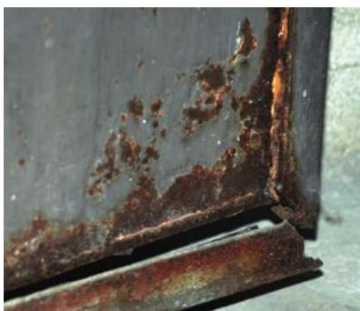
شکل (۱۴-۳) زنگ زدن آهن
