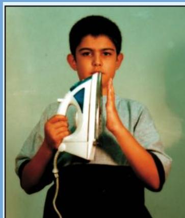
لین اتو را به برق وصل کرده و پس از مدتی که گرم شد آن را از برق بکشید. سپس آن را به صورت عمودی قرارداده و دست خود را در نزدیکی آن همانند شکل قرار دهید.
